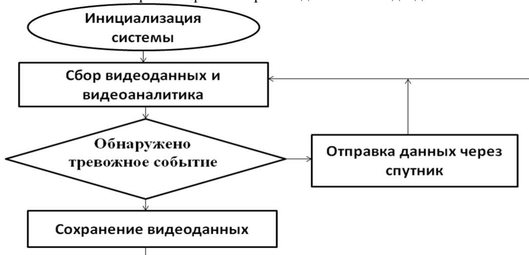
Рис. 3. Блок-схема алгоритма работы системы видеонаблюдения.
