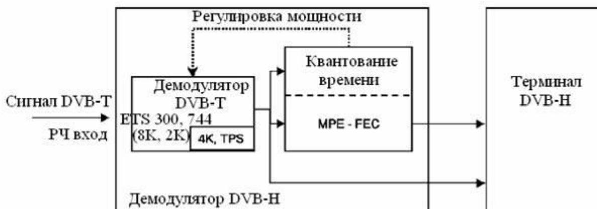
Рисунок. 1 Концептуальная структура приемника DVB-H
