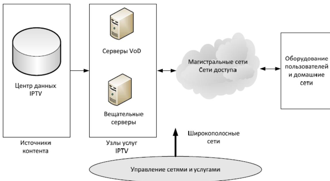
Рис.1. Обобщенная структурная схема архитектуры IPTV
