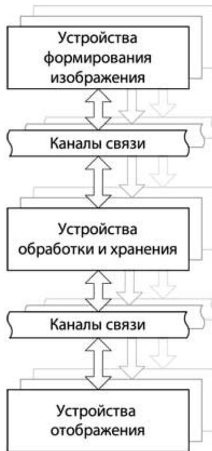
Рис. 1. Обобщенная структурная схема системы ТВ-наблюдения
