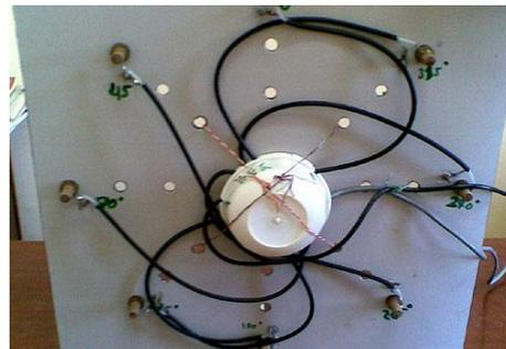
Рис.1.3 Конструкция антенны и система питания монополей
