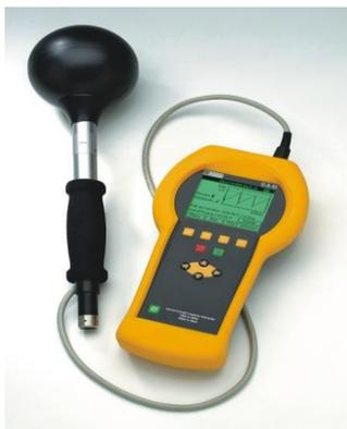
Рис. 2.3. Низкочастотный измеритель напряжения электромагнитного поля (C.A 42).
