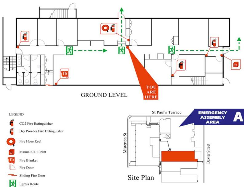
Рис. 5.4. Диаграмма пожарной эвакуации
