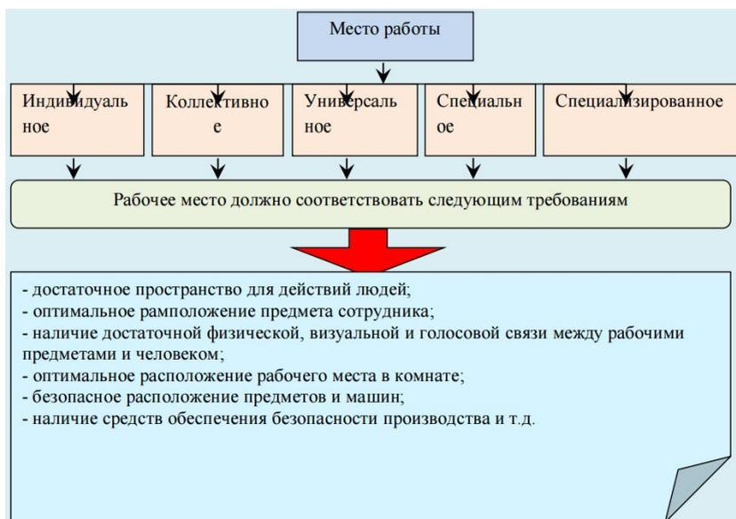
Рис. 7.1. Требования безопасности для рабочих мест разных форм
