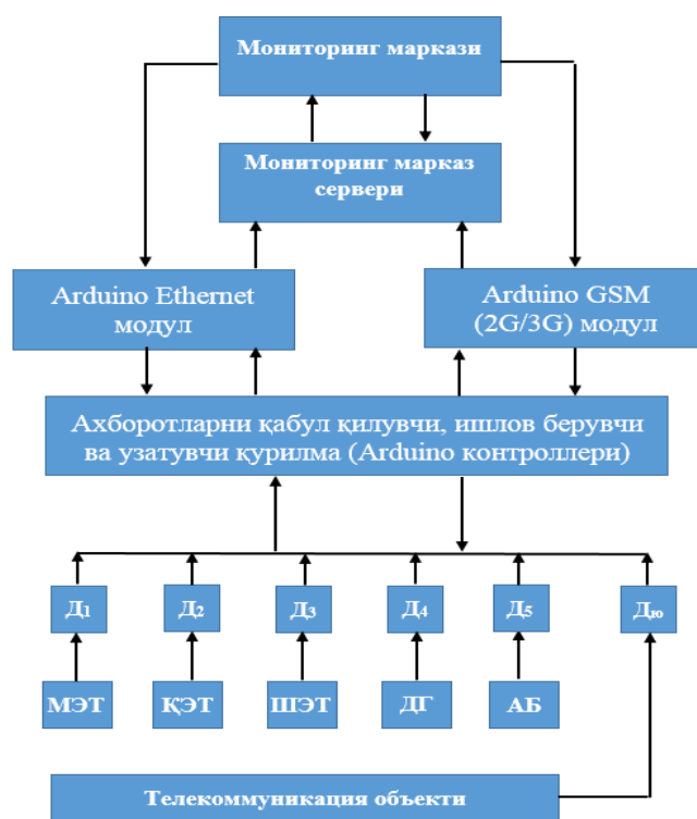
2-расм. Бошқарув жараёнини масофали мониторинг қилиш тизимининг тузилиш схемаси
