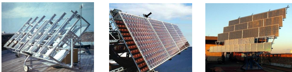
2- расм. Концентрланган қуёш нурини электр энергияга ўзгартурувчи автоном фотоэлектрик станция модуллари
