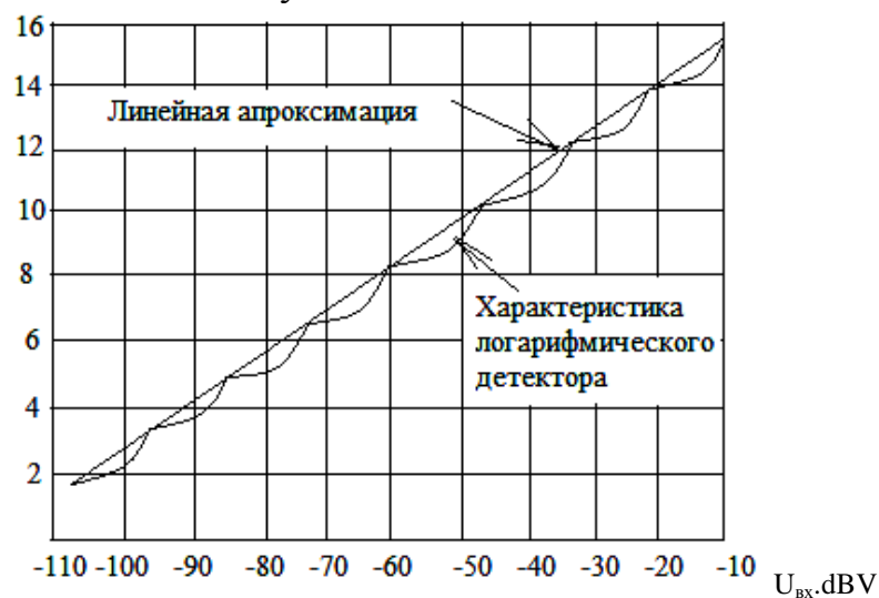
Рис.2. Характеристика идеального логарифмического детектора.
