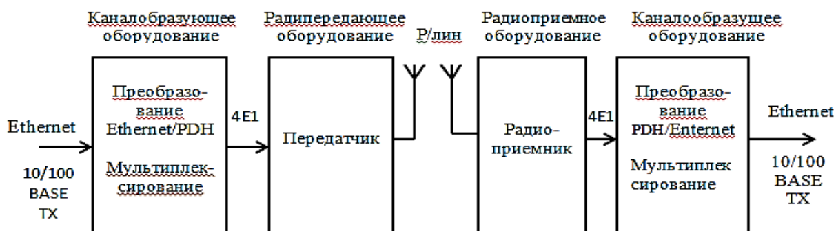
Рис.1. Структурная схема системы передачи
