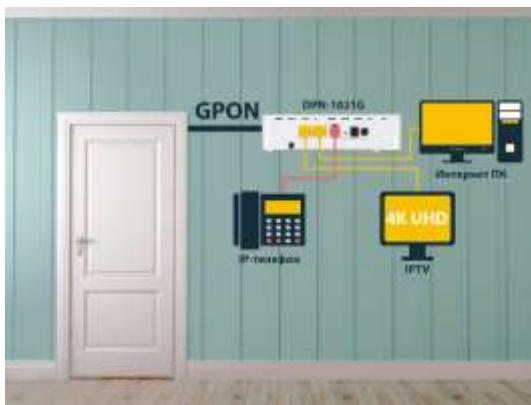
2-rasm. GPON texnologiyasi uy ichidagi ulanish strukturasi
