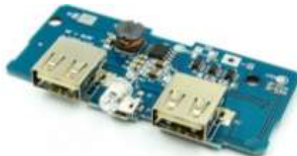
Рис. 6. Зарядный модуль литий полимерных батарей LiPo Литий-ионный аккумулятор. В качестве источника постоянной питания выбран аккумулятор с номиналом 3.7V 4000 мАч.
