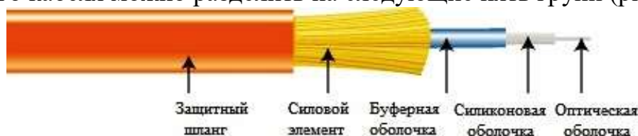
Рисунок 1. Основные компоненты защиты оптического кабеля
